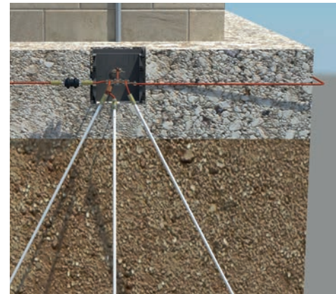
Fig. 13 – Sección transversal de una puesta a tierra.
