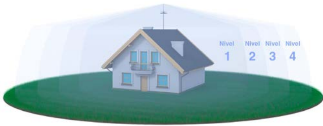
Fig. 4 – Volumen de protección de un PDC.
